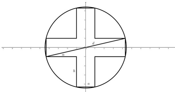
Abbildung 17: Querschnitt einer Spule mit Eisenkern.
