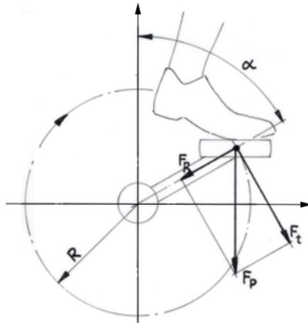
Berechnen Sie die Teilkräfte  $\vec{F}_R$ ,  $\vec{F}_t$  sowie das Drehmoment  $\vec{M} = \vec{r} \times \vec{F}_p$ .
